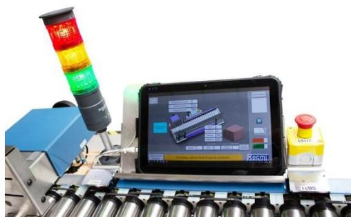
Le COBOFOLDER de RECMI est équipé d'une interface tactile simple d'utilisation (tablette tactile). Son logiciel d'aide à la palettisation permet de définir les plans de palettisation qui seront utilisés et réduit les temps de réglages et paramétrages.
