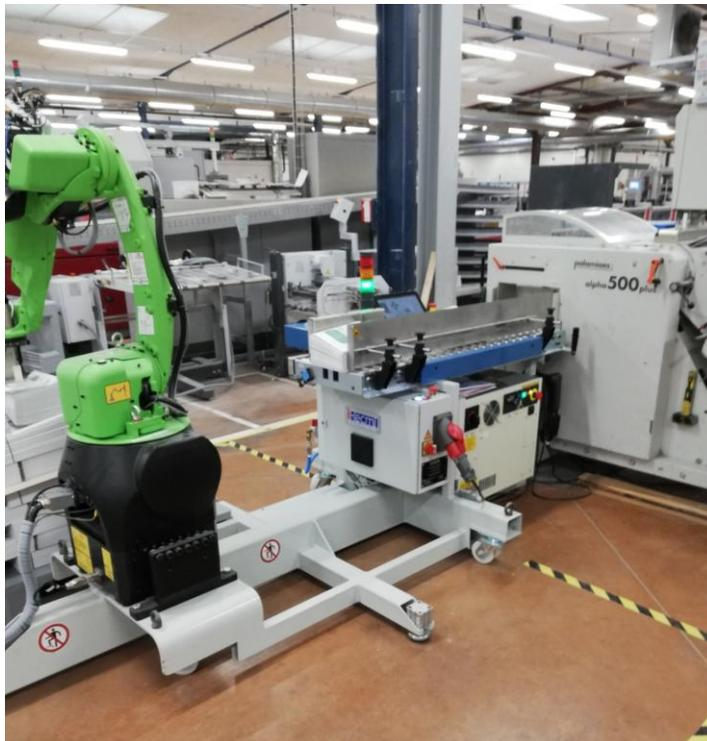
Le COBOFOLDER de RECMi Industrie est un palettiseur robotique collaboratif qui permet de palettiser les produits issus de lignes de finition, de plieuses (produits pliés, dos carrés collés de formats divers).
