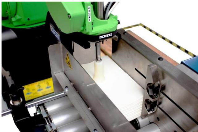
L'outil spécifique, système de pince ou préhenseur à fourches, assure précision de prise et de dépose des piles et permet de traiter des formats divers tout en assurant le respect des produits.
