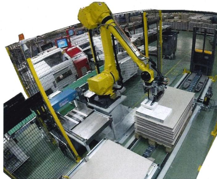
La ligne de convoyage en sortie des empileurs permet l'acheminement des piles de blocs cousus jusqu'au module de prise. Ce dernier est équipé d'un taquage 4 faces qui assure un respect du produit lors de la prise ainsi qu'une qualité de palettisation optimale.
